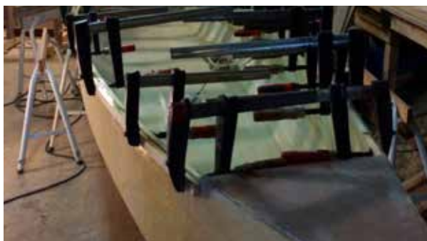
Reling og afstivning på sættes
