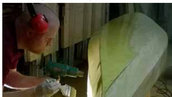
Glasfiber bliver påført
